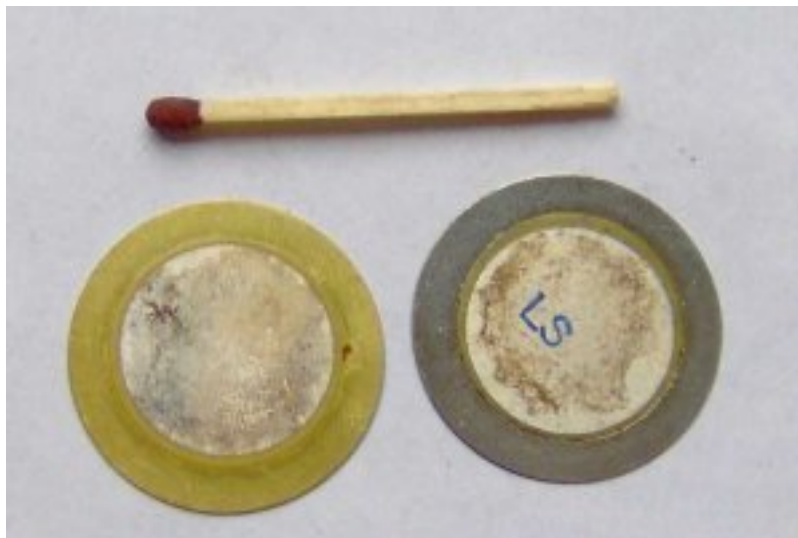
FIGURE V.2.16. – Éléments piézoélectriques de montre - (CC-BY-SA, FDominec )
