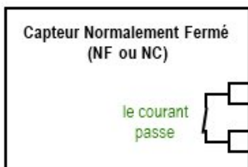
FIGURE V.2.2. – Schéma d'un capteur normalement fermé
